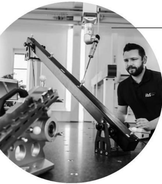
Die Akkreditierung nach DIN EN ISO 17025:2018 weist unsere Kompetenz in der Ermittlung der Maß- und Formabweichung industriell gefertigter Produkte und Bauteile mit Hilfe von taktilen 3D-Koordinatenmesssystemen nach.
